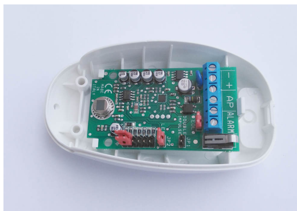
Rysunek 34: Czujka 'Smile' skonfigurowana w 2EOL/NC.
